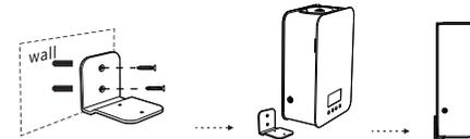
1. Scegliere la posizione desiderata sul muro, successivamente fissare la staffa al muro con le viti, come mostrato nel precedente passaggio.
